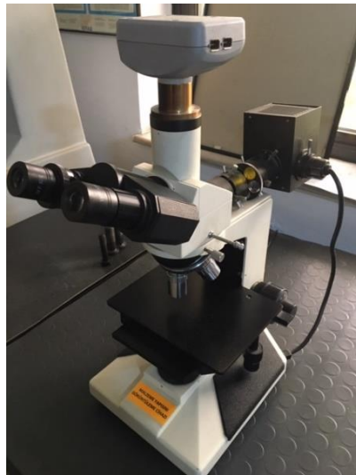
Şekil 2.3. Nikon MA 200 Invert tipi optik metal mikroskobu
