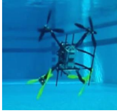
Şekil 1.8 Sualtından havaya geçiş yapabilen ilk prototip oktokopter (Maia vd., 2015)
